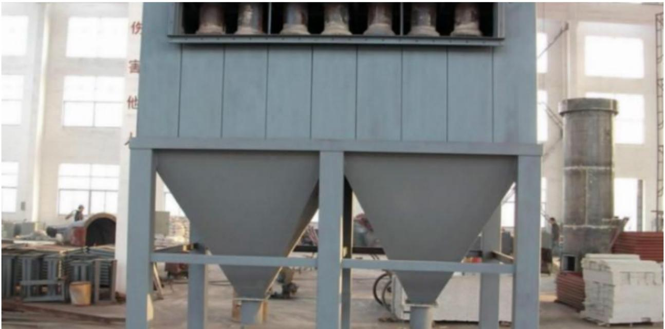
滤袋清灰，除尘器运行一段时间后，滤袋表面粘附和聚集起一定厚度的烟尘，通过控制反吹阀，布袋表面烟尘。滤袋除尘器设在引风机负压区，使除尘系统处于负压状态下工作，这有利于延长引风机的使用寿命和避免被烟尘磨损。为了保证滤袋正常工作，还设置旁路烟道及阀门锅炉检修烘炉及点火时使用含油烟较多的燃料对滤袋的影响而临时开通使用。负压反吹滤袋除尘器结构简单，占地面积小(30m<sup>2</sup>以内)，可根据生产需要进行现场灵活设计布局。负压反吹滤袋除尘器净化含尘气体能力强，能有效地控制污染，尤其是净化后烟尘排放浓度明显低于国家规定排放标准，可应用于中小型工业锅炉，除尘效率可达98%以上。负压反吹滤袋除尘器生产运行费用较低，能源消耗与同类
