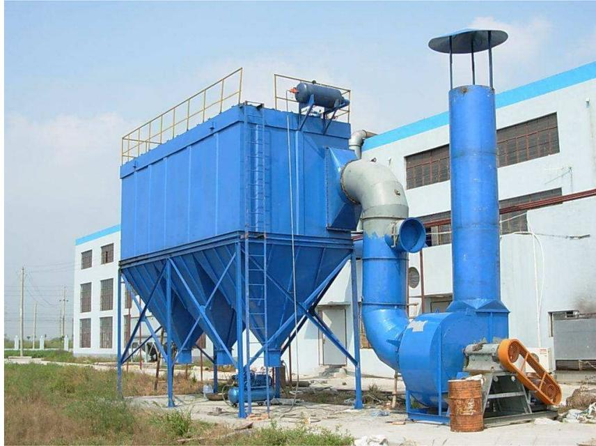
根据粉尘性质粉尘性质包括比电阻、粒度、真密度、飘性、憎水性和水硬性、可燃、等。比电阻过大或过小的粉尘不宜采用电除尘器，袋式除尘器不受粉尘比电阻的影响；粉尘的浓度和粒度对电除尘器效率的影响较为，但对袋式除尘器的影响不；当气体的含尘浓度较高时，电除尘器前宜设置预除尘装置；袋式除尘器的型式、清灰方式和过滤风速取决于粉尘的性质（粒径、飘性）；湿式除尘器不适合于净化憎水性和水硬性的粉尘；粉尘的真密度对重力除尘器、惯性除尘器和旋风除尘器的影响；对于新附性大的粉尘，易导致除尘器工作面猫结或堵塞，因此，不宜采用干法除尘；粉尘净化遇水后，能产生可燃或有危险的混合物时，不得采用湿式除尘器。4. 根据压力损失与能耗袋式除尘器的阻力比电除尘器的阻力大，但从除尘器整体能耗来对比，两者能耗相差不大。5. 根据设备投资和运行费用6. 节水与防冻的要求水资源缺乏的地区不适合采用湿式除尘器；北方地区存在冬季冻结的问题，尽可能不使用湿式除尘器。
